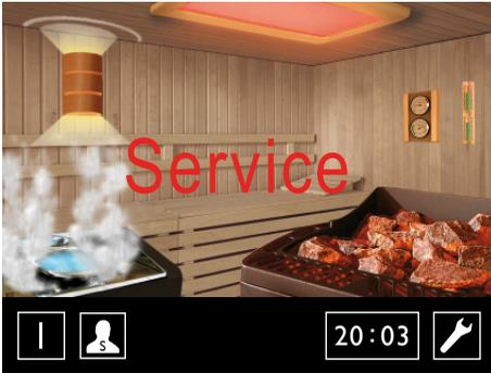
Beim Überschreiten der eingestellten Serviceintervallzeit blinkt, beim Einschalten der Anlage, für ca. 15 Sek. das Wort „Service“ in roter Schrift auf dem Display.
