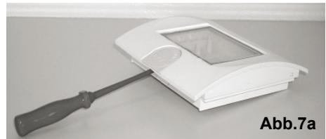
Anschließend muss das Gehäuseoberteil an den hinteren Befestigungslaschen ausrasten (siehe Abb.8).
