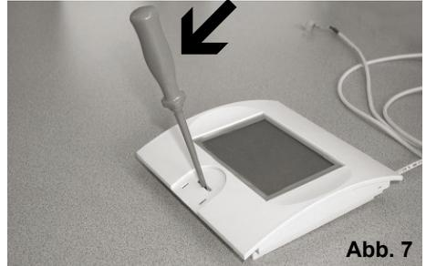
Entriegeln Sie das Gehäuse durch leichtes Drehen oder Kippen des Schraubendrehers in Pfeilrichtung (Abb.7) und schwenken Sie das Gehäuseoberteil nach oben.
